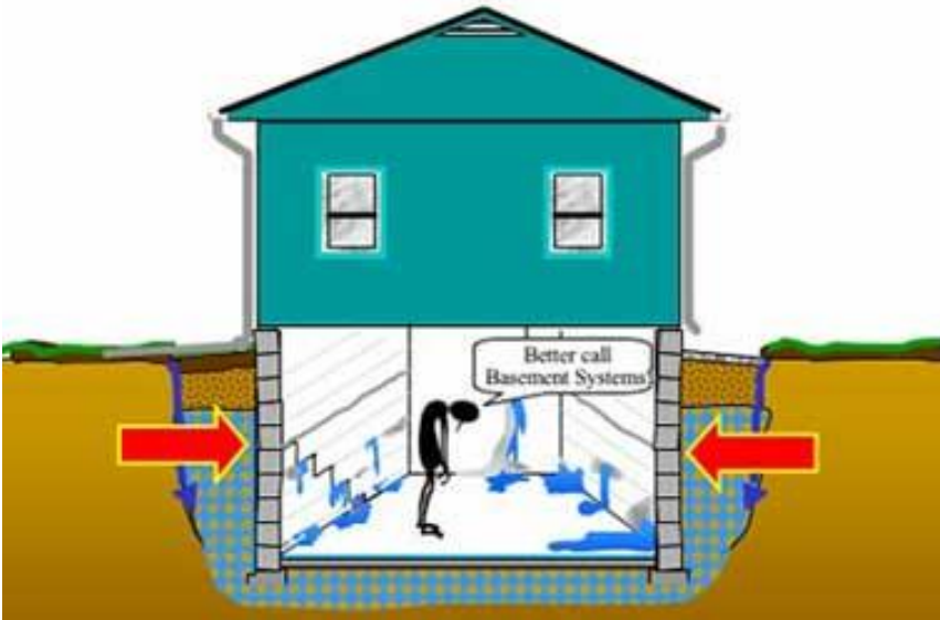
Kuva 2. Havainnekuva vesipaineesta (hydrostaattinen paine)
